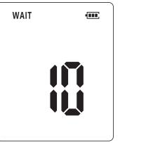
③ 「START」に表示が切り替わると同時にピッと音が鳴り「6→5→…2→1」とカウントダウン表示されますので、この間に息を吹きかけてください。
