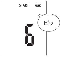
④ 呼気が検知されるとピート音が鳴り続けるので、この間も息を吹き続けます。この際には「4→3→2→1」とカウントダウン表示され、最後にピッと音が鳴り、測定値が表示されます。
